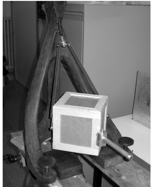
Figura 3. A l'esquerra, el suport de la massa oscil·lant del macrosismògraf Cartuja, única part que va trobar-se de l'aparell en l'estat en què va arribar al taller de restauració. A la dreta, estat actual de la reconstrucció de l'instrument.
