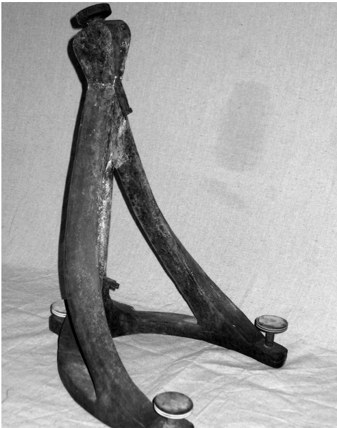
Figura 3. A l'esquerra, el suport de la massa oscil·lant del macrosismògraf Cartuja, única part que va trobar-se de l'aparell en l'estat en què va arribar al taller de restauració. A la dreta, estat actual de la reconstrucció de l'instrument.
